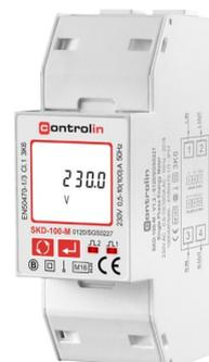
Das SKD-100-M ist ein neues Energiemessinstrument in zeitgemäßem Design zur Erfassung und Anzeige von maßgeblichen elektrischen Werten. Durch einphasigen Betrieb und die Datenausgabe über RS485 Modbus-Schnittstelle und Impulsausgang, ist ein breiter Anwendungsbereich möglich.
